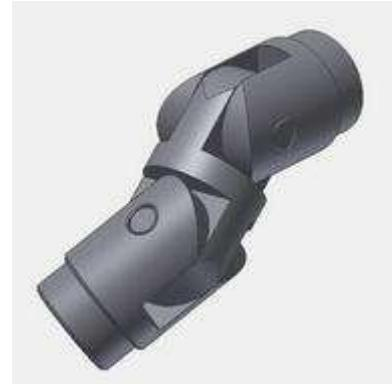
**Раздвижной карданный вал** изготовлен из нержавеющей стали или стали с оцинкованием, предназначен для поворотного соединения труб. Работает в двух плоскостях под углом 90 градусов. Ассортимент включает в себя соединение для подвесных линии диаметром 60,3 и 48,3 мм.
