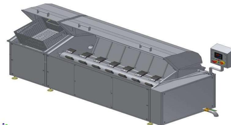
находится система обогрева паром, два вала для снятия щетины свиных туш наружу. Ванна изолированная.
