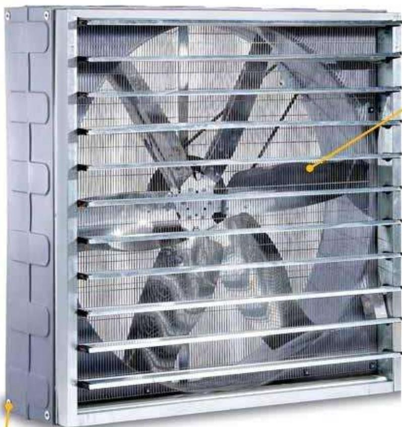
Вентиляторы имеют по шесть лопастей специальной формы из нержавеющей стали для увеличения объема нагнетаемого воздуха при низких оборотах и снижения уровня шума и энергопотребления
