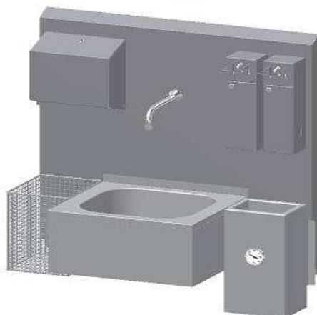
Панель чистоты 1100x1100x80 мм оборудована: умывальник, дозатор мыла, дозатор дезинфицирующего средства, подаватель бумажного полотенца, сетчатая корзина, стерилизатор ножей, включение коленом
